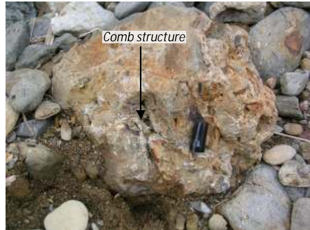
Gambar 4. Bongkah urat karsa dengan comb structure mengandung pirit di Sungai Jangga, Lumban Julu.
