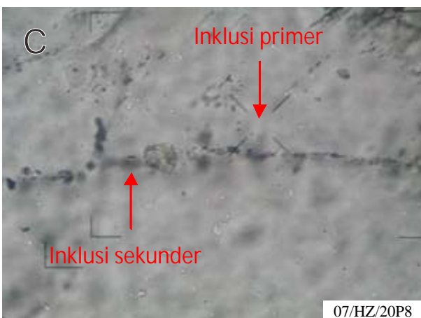
Gambar 5. Foto mikro (tanpa skala) tipe inklusi fluida dalam urat karsa dari Sungai Jangga (contoh 07HZ08 K (a), FL/07HZ (b), 07/HZ/20P8 (c) dan 07/HZ/20P3 (d)). Foto (a) sebaran inklusi cair primer, foto (b) inklusi primer berbentuk negative , foto (c) mikroinklusi fluida primer dan sekunder, dan foto (d) mikroinklusi fluida primer dan sekunder. Catatan: inklusi fluida sekunder tidak dapat di analisis karena tidak memenuhi syarat.
