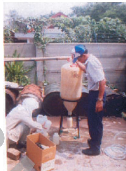
Gambar 1. Pemercontohan air tanah dalam untuk analisis ^{14}\text{C} dengan teknik pengendapan \text{BaCO}_3 .
