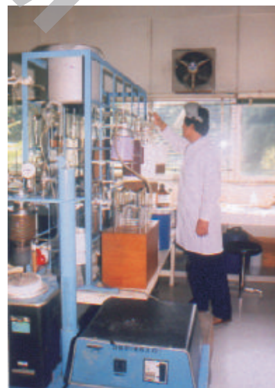
Gambar 2. Analisis percontoh untuk mengukur umur air tanah dengan metode Radiokarbon
