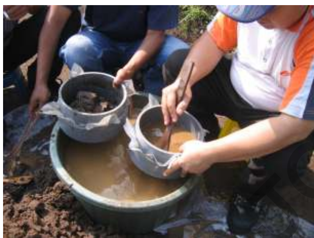
Gambar 1. Proses penyaringan sedimen sungai dengan saringan nilon, ukuran 80 mesh, contoh yang dipakai -80 mesh. (sumber: Irzon dan Kurnia, 2013)
