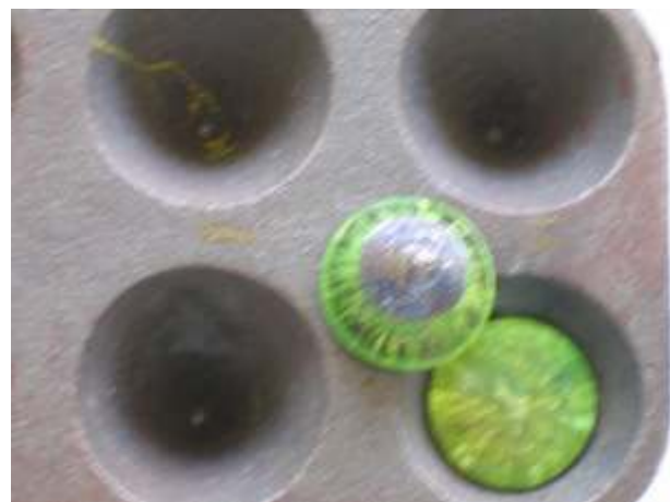
Gambar 4. Hasil reaksi fusi di iron mould. Bagian kerucut yang berwarna abu adalah lead button , bagian berwarna kehijauan adalah slag.
