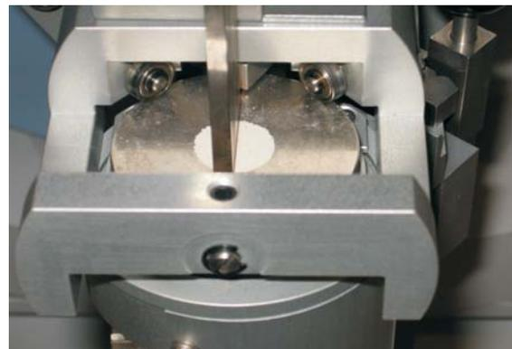
Gambar 4. Posisi percontoh pada tempat percontoh (*sample holder*) terputar pada dudukan percontoh (*sample stage*) saat perekaman data uji.
