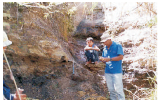
Potret 8. Singkapan batulempung dan sisipan batubara di Desa Gatareng.
