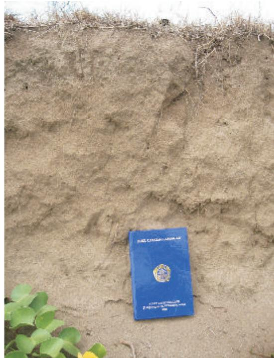
Foto 3b. Singkapan pasir berbutir halus sampai menengah pada Jalur Pasir Pematang Pantai 3.
