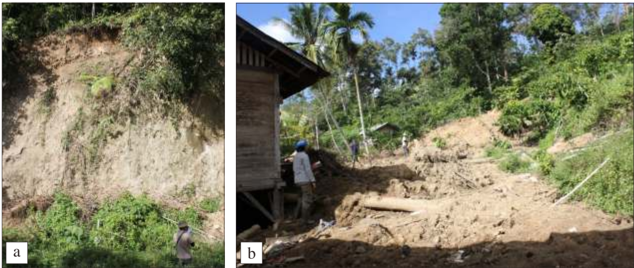
Gambar 4. Singkapan tuf pasir (a) dan tanah residu coklat (b) jalur Transek Liwa-Ranau
