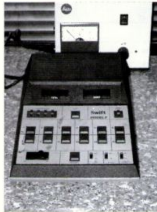
Gambar 4. Mikroskop polarisasi Leica-DMRP dilengkapi point counter Swift-F yang digunakan pada pengujian petrografi terperinci batugamping Formasi Baturaja di daerah penelitian.
