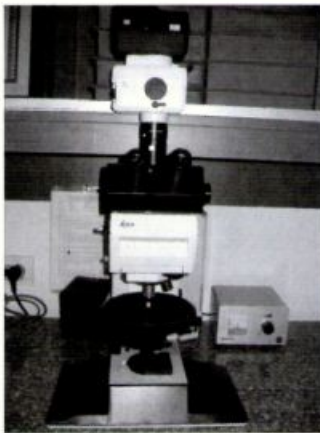
Gambar 4. Mikroskop polarisasi Leica-DMRP dilengkapi point counter Swift-F yang digunakan pada pengujian petrografi terperinci batugamping Formasi Baturaja di daerah penelitian.
