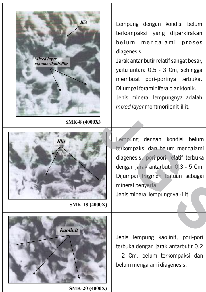
Gambar 3. Foto mineral lempung berdasarkan hasil analisis SEM.
