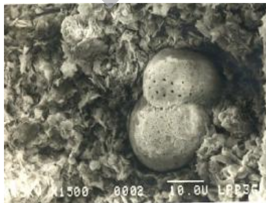
Percontoh I-32 Kaolinit dan campuran antara monmorilonit dan illit, sangat padat dan terlihat cangkang fosil foraminifera di dalamnya.
