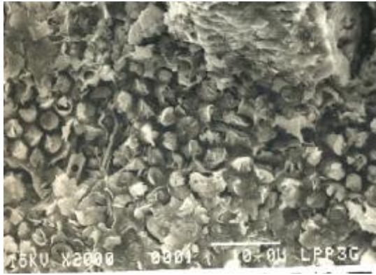
Contoh I-32 : Monmorilonit atau klorit yang menunjukkan struktur anggur, ilit dan kalsit terlihat di bagian atas sebelah kanan dan kaolinijelas terlihat di bagian kiri atas.
