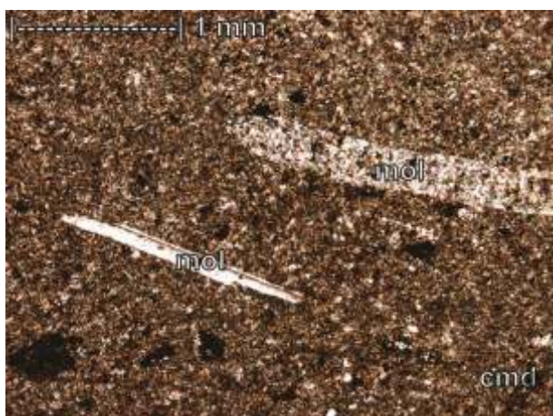
Gambar 13. Wackestone penyusun bagian bawah Formasi Wonosari yang terdukung matriks lumpur karbonat (cmd) dengan fosil moluska (mol) yang telah maupun yang belum tergantikan. Kode sampel SGT208B, kedudukan lensa nikol bersilang.
