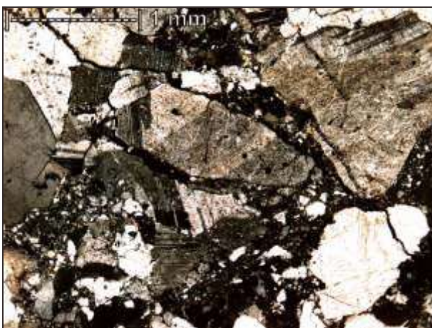
Gambar 5. Granit 06DR13A yang tampak retak-retak, terhancurkan dan berubah.
