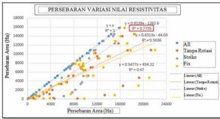
Gambar 11. Kurva penyebaran variasi nilai resistivitas pada 30 titik pengukuran berdasarkan model tanpa rotasi, model rotasi *strike angle*, dan model rotasi *fix angle*. Hasil terbaik ditunjukkan oleh jenis rotasi *strike angle* dengan nilai determinasi ( $R^2$ ) mencapai 0.7735
