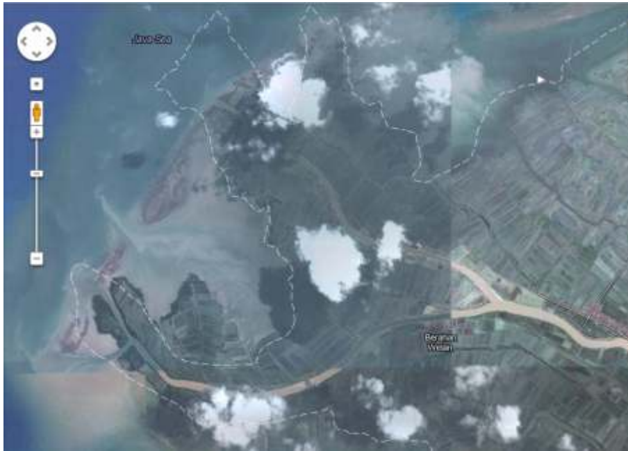
Gambar 9. Pertumbuhan atau perubahan garis pantai yang cukup dinamis. Garis putih adalah merupakan garis pantai yang lama.
