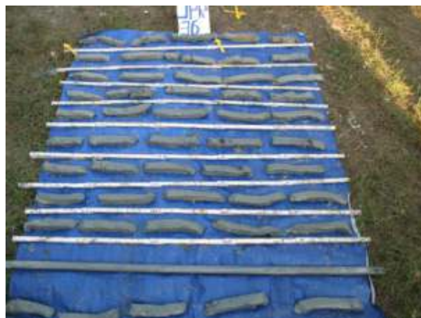
Gambar 8. Endapan laut dangkal ( shallow marine deposits ) sangat homogen mengindikasikan lingkungan tenang, komposisinya terdiri atas lempung abu-abu kehijauan, lunak, liat dan lengket mengandung fosil moluska dan gastropoda.
