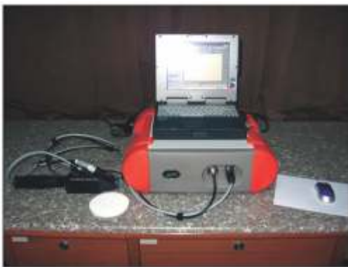
Gambar 2. Peralatan ASD yang dirangkai di atas meja dan siap dioperasikan.
