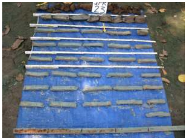
Gambar 8. Kenampakan endapan laut dekat pantai yang secara menerus diendapkan mulai dari batuan alas hingga ke bagian atas (homogen).
