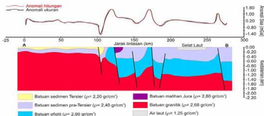
Gambar 7. Model geologi bawah permukaan sepanjang lintasan AB berdasarkan analisis pola anomali residual.
