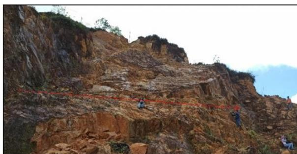
Gambar 8. Bentangan scanline pada lereng 4
