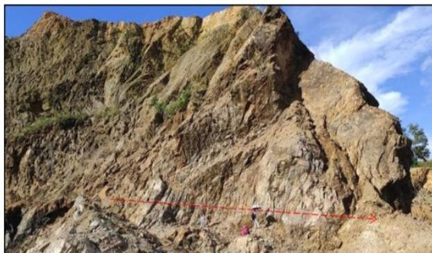
Gambar 7. Bentangan scanline pada lereng 3
