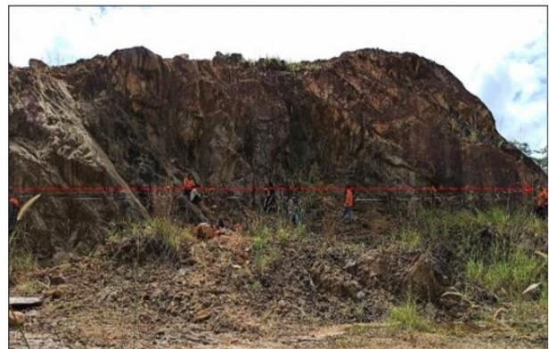
Gambar 5. Bentangan scanline pada lereng 1
