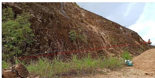
Gambar 9. Bentangan scanline pada lereng 5
