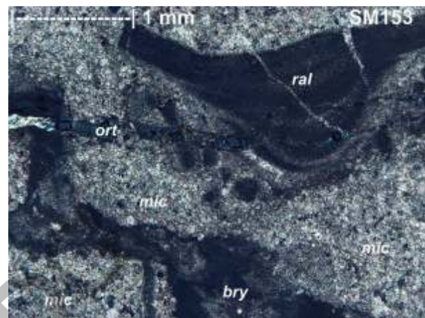
Gambar 16. Wackestone dengan beberapa fosil pengerakan ganggang merah (ral), bryozoa (bry) yang tersebar di dalam matriks lumpur karbonat tergantikan menjadi mikrospirit (mic), dengan pengisian retakan oleh orthospirit (ort). Batuan ini menyusun bagian atas Formasi Jonggrangan. Kode sampel SM153, kedudukan lensa nikol bersilang.
