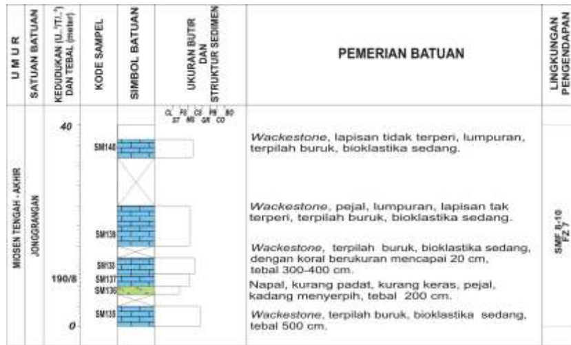
Gambar 6. Kolom stratigrafi bagian tengah Formasi Jonggrangan di lintasan Gua Kiskendo, pada Segmen 3. Lihat Gambar 3 untuk lokasi pengukuran stratigrafi rinci.
