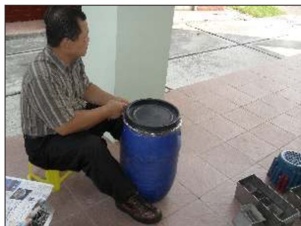
Gambar 5. Drum untuk homogenisasi melalui pengelindian 24 jam.
