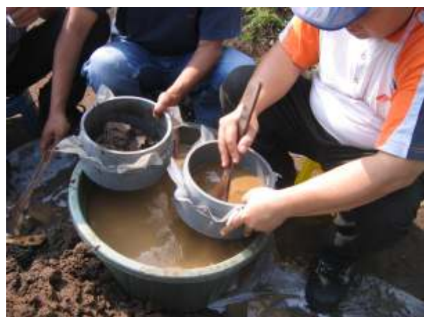
Gambar 3. Proses penyaringan sedimen sungai dengan saringan nilon, ukuran 80 mesh, contoh yang dipakai -80 mesh.
