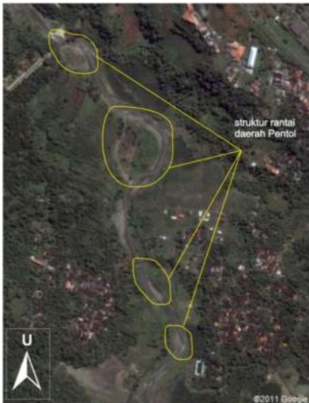
Gambar 2. Pola bentukan pointbar yang berderet sebagai indikasi adanya aktivitas tektonik berupa sesar mendatar terdapat di daerah Pentol bagian tengah dari jalur Kali Garang (Data citra: Google earth , 2011).
